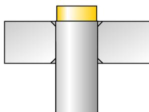
Все монтируемые не заподлицо цилиндрические датчики *iprox*®+ можно ввинчивать до верхней грани корпуса. Безопасная работа версии Ø 6,5 мм гарантируется при уменьшении макс. на 30% дистанции срабатывания.
