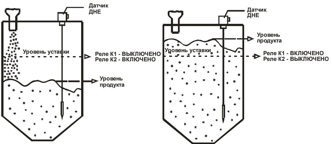
Рис.4. Состояния реле K1 и K2 в однопороговом режиме работы (режим 1).
