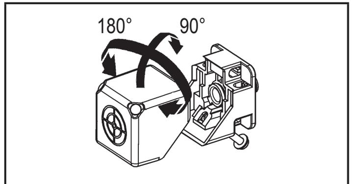
2. Antennenkopf vom Befestigungselement trennen und drehen.
