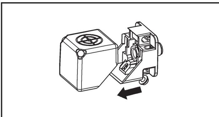
3. Befestigungselement und Antennenkopf zusammenstecken.
