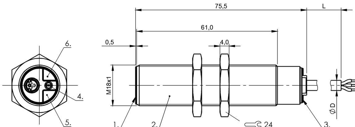
1) Активная поверхность, 2) Корпус, 3) Крышка, 4) Потенциометр, 5) СД напряжения питания, 6) Функциональный СД
