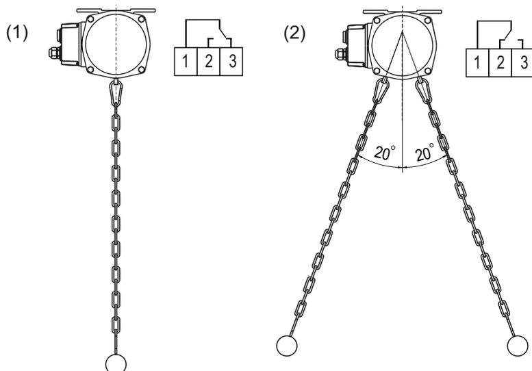
1. В свободном состоянии цепь с чувствительным грузом располагается вертикально, замкнуты контакты 1 и 3 микровыключателя.
