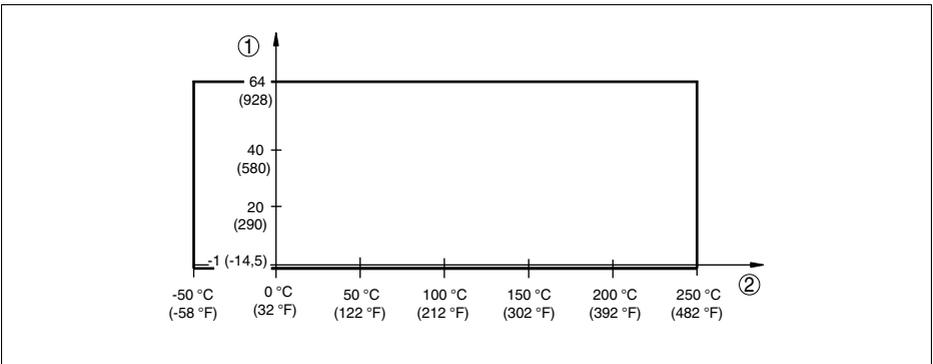
Abb. 32: Prozesstemperatur - Prozessdruck bei Schalterstellung 0,7 g/cm<sup>3</sup> (Betriebsartumschalter)
