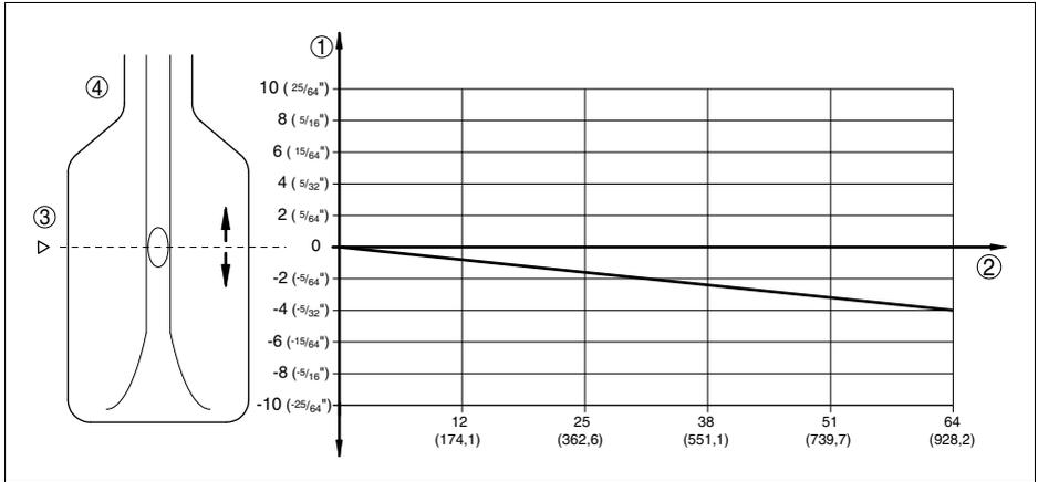
Abb. 30: Einfluss des Prozessdrucks auf den Schaltpunkt
