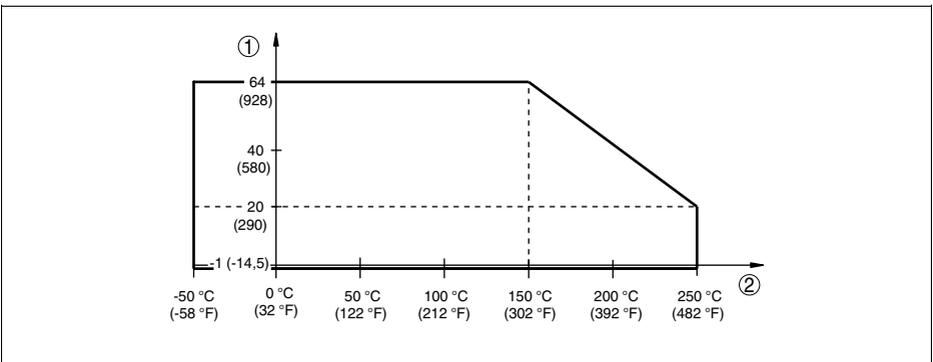
Abb. 33: Prozesstemperatur - Prozessdruck bei Schalterstellung 0,5 g/cm<sup>3</sup> (Betriebsartenumschalter)
