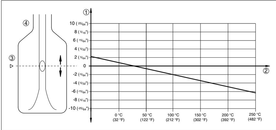
Abb. 28: Einfluss der Prozesstemperatur auf den Schaltpunkt
