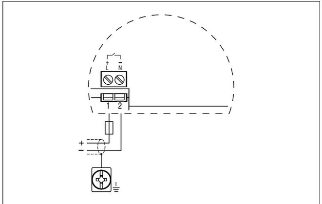
Abb. 10: Anschlussplan Einkammergehäuse
