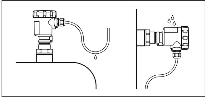
Abb. 6: Maßnahmen gegen das Eindringen von Feuchtigkeit
