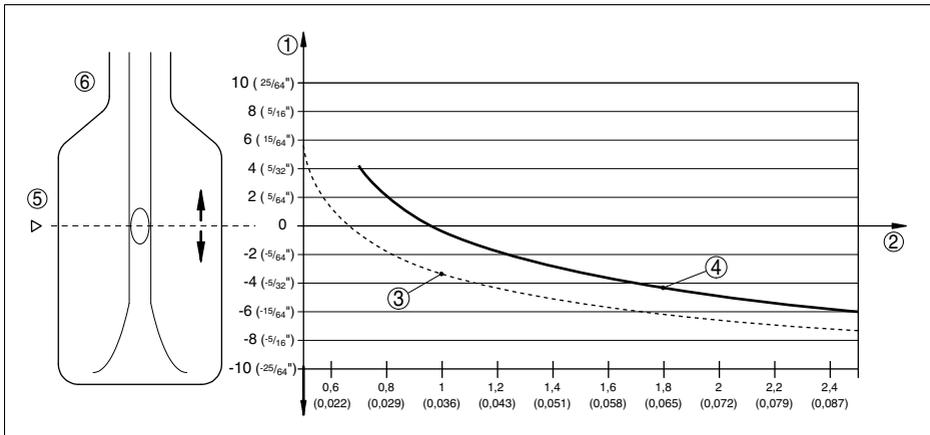
Abb. 29: Einfluss der Füllgutdichte auf den Schaltpunkt
