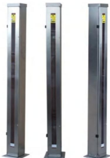
Напыление пластикового материала на нержавеющую сталь и холодную стальную пластину обеспечивает защиту световой завесы. Встроенный электрический нагреватель стекла, регулятор температуры и регулятор влажности реализуют автоматический нагрев при слишком высокой влажности и слишком низкой температуре, чтобы обеспечить надежное использование светового занавеса для разделения транспортных средств в сырых районах, в дождливую и снежную погоду, в холодное время года.
