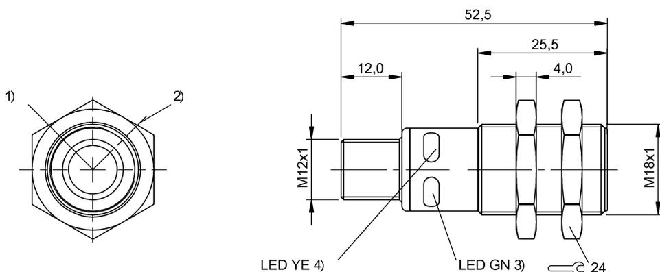
1) Ось ультразвукового преобразователя, 2) Направление отхода 90° штекер, 3) Напряжение питания, 4) Функция выхода
