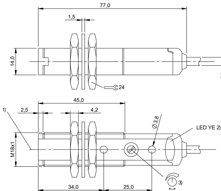
1) Оптическая ось, 2) Функция выхода, 3) Sn
