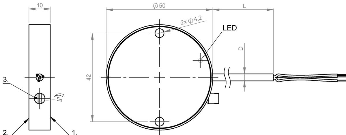
1) Активная поверхность, 2) Корпус, 3) Потенциометр, 4) Функциональный СД
