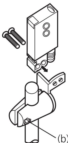
Ziehen Sie nach Montage und Ausrichtung des Sensors die Schraube (b) fest.
