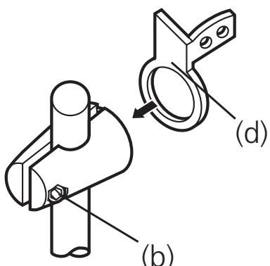
Befestigen Sie den Haltewinkel (d) und ziehen Sie anschließend die Schraube (b) soweit an, daß sich der Winkel noch drehen läßt.
