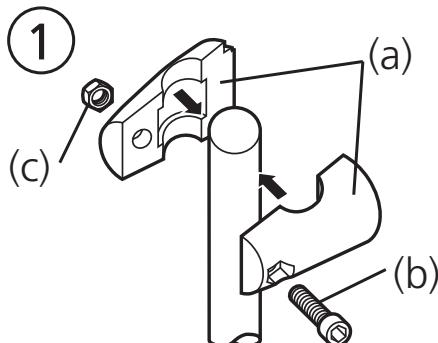
Montieren Sie die beiden Schellenhälften (a) lose mit Hilfe der beiliegenden Schraube (b) und Mutter (c).
