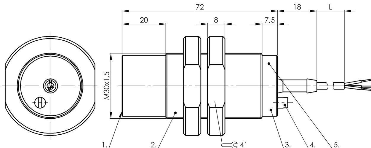
1) Активная поверхность, 2) Корпус, 3) Крышка, 4) Потенциометр, 5) Функциональный СД
