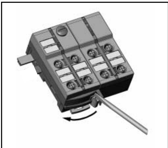
Verlegen Sie das AS-i Flachkabel sorgfältig, der gerade Verlauf des Flachkabels soll ca. 15 cm betragen.
