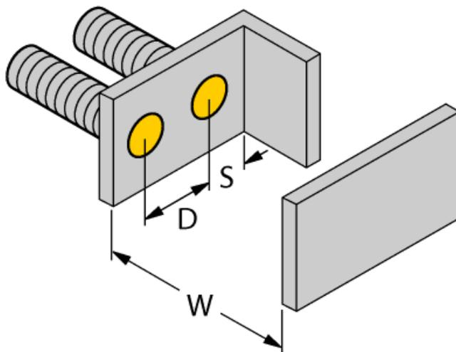
Указанные минимальные расстояния протестированы при стандартном расстоянии переключения. Если необходимо изменить чувствительность датчиков при помощи потенциометра, характеристики из технического описания более не применимы.
