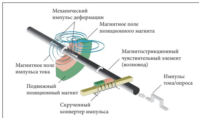
Рис. 1: Магнитострикционный принцип
