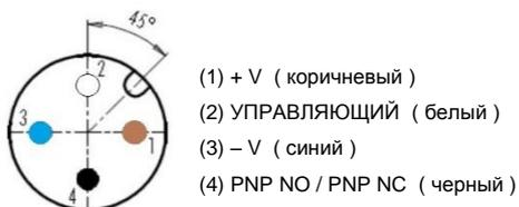
Датчик с разъемом M12, 4-pin, штекер "папа",
