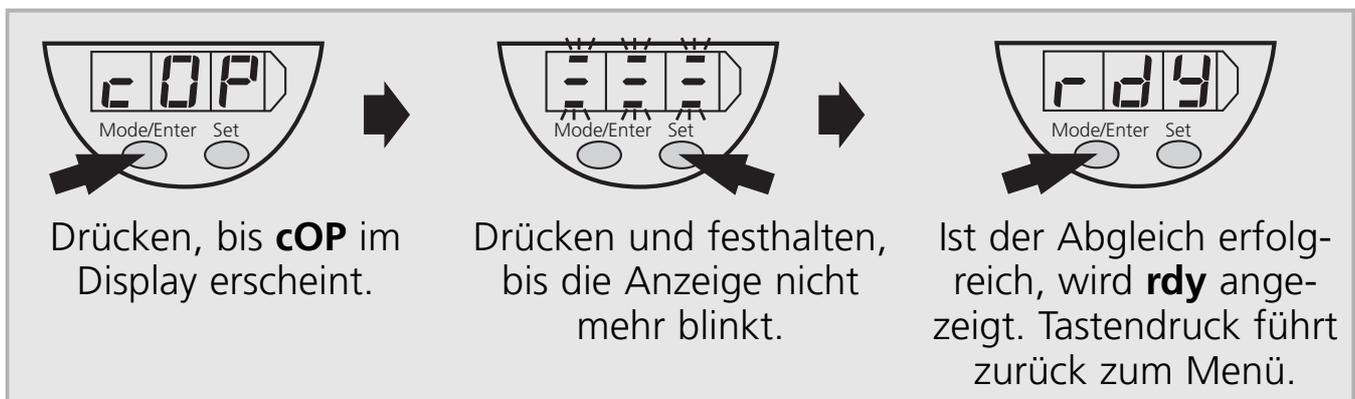
Während des Abgleichs überprüft der Sensor die Einbausituation. Ist z.B. ein Montage-Mindestabstand unterschritten, erscheint im Display eine Fehlermeldung (siehe Bedienungsanleitung, Allgemeiner Teil).
