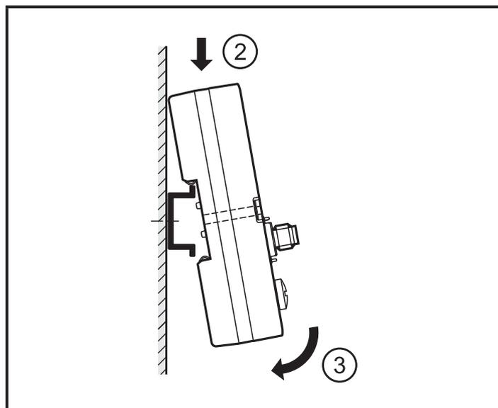
1. Incliner l'appareil et positionner le clip de fixation sur l'arête supérieure du rail DIN.
