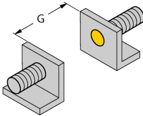
Указанные минимальные расстояния протестированы при стандартном расстоянии переключения. Если необходимо изменить чувствительность датчиков при помощи потенциометра, характеристики из технического описания более не применимы.
