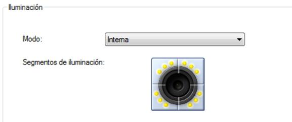
La iluminación interna mediante LED del sensor está dividida en cuatro segmentos. Mediante la desactivación de segmentos individuales se pueden evitar reflexiones no deseadas en el objeto de evaluación.
