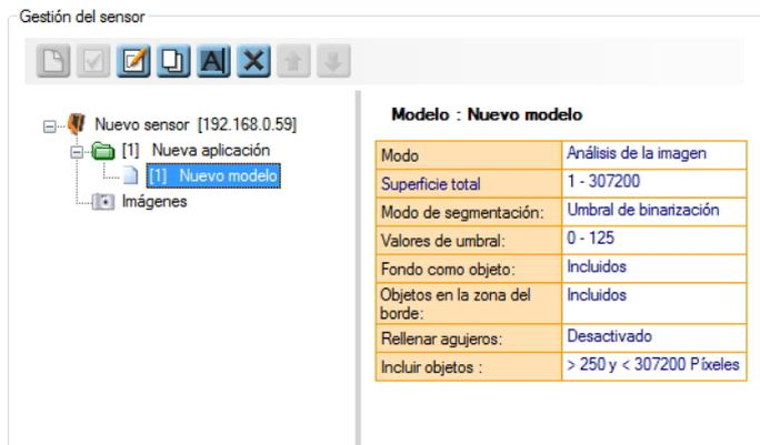
En el directorio de aplicaciones se encuentra una lista con el sensor conectado y las aplicaciones guardadas. En cada sensor se pueden almacenar como máximo 32 aplicaciones, cada aplicación puede contener hasta 24 modelos. (→ Capítulo 8.3 Modelos)
