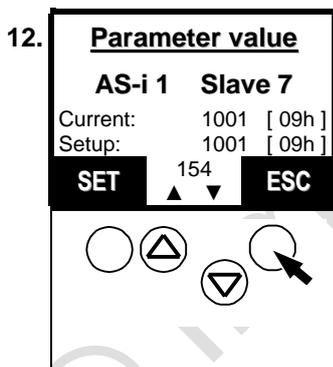
> Setup value of the parameter data is copied to the current parameter data
