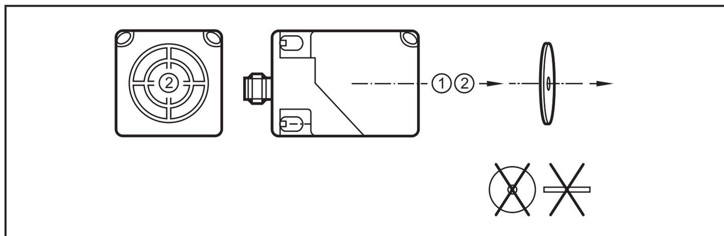
1: axe de l'antenne ANT512 = axe du TAG
