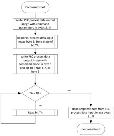
Hinweis: Es ist zulässig, den Kommandomodus und den Kommandoparameter zusammen mit Bit TR = NOT (TA) innerhalb eines SPS-Zyklus zu setzen, um das Kommando zu aktivieren.
