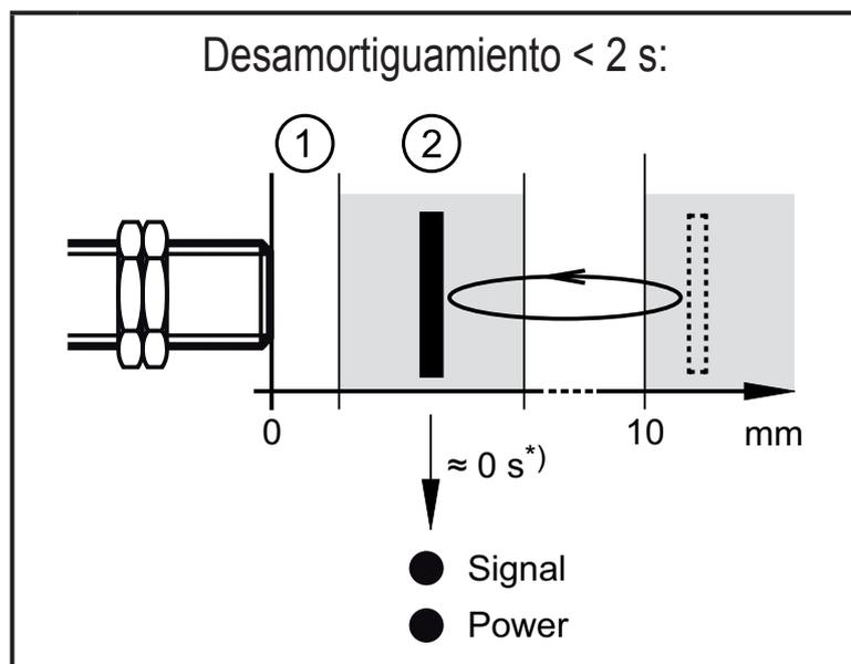
En caso de que el elemento amortiguador esté menos de 2 s separado del detector ( $> 10 \text{ mm}$ ), el LED de señal amarillo se enciende sin retardo en caso de producirse un amortiguamiento en la zona de accionamiento.
