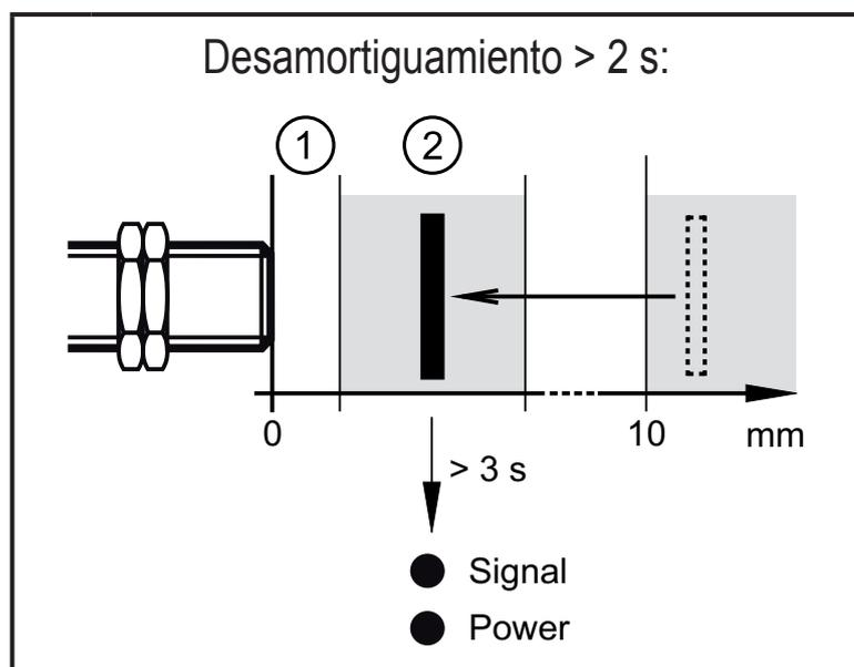
En caso de que el elemento amortiguador esté más de 2 s separado del detector (> 10 mm), el LED de señal amarillo se enciende con un retardo de 3 s aprox. en caso de producirse un amortiguamiento en la zona de accionamiento.
