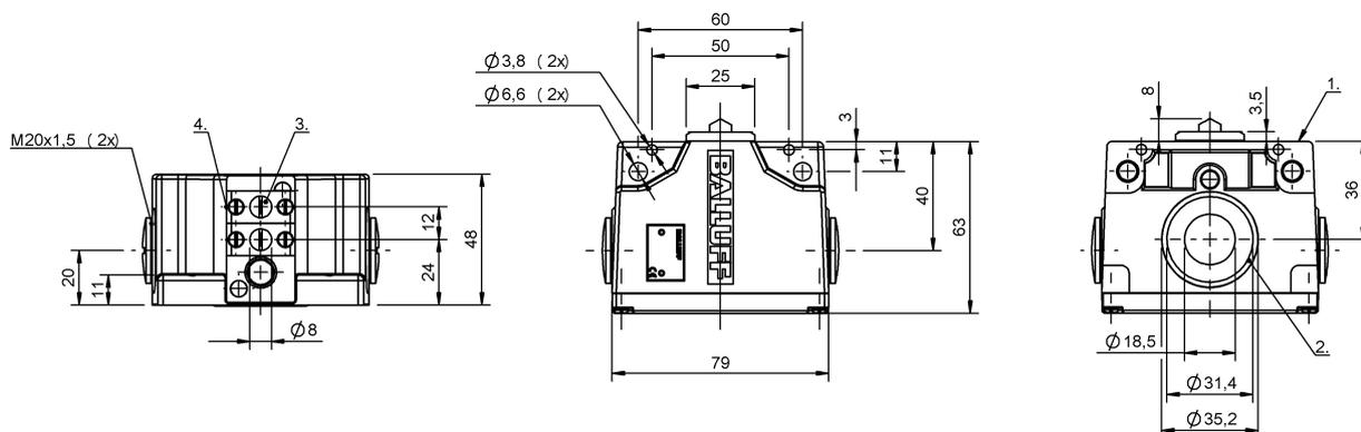
1) Опорная кромка, 2) Уплотнительное кольцо, 3) Противокристаллизационный толкатель, 4) Марк. Безопасн. точка переключения
