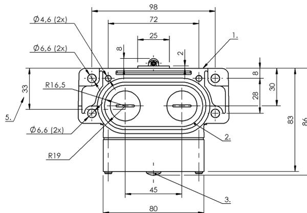
1) Опорная кромка, 2) Уплотнительное кольцо, 3) Функциональный индикатор FD/FE/LL, 4) Марк. Безопасн. точка переключения, 5) Кабельный ввод
