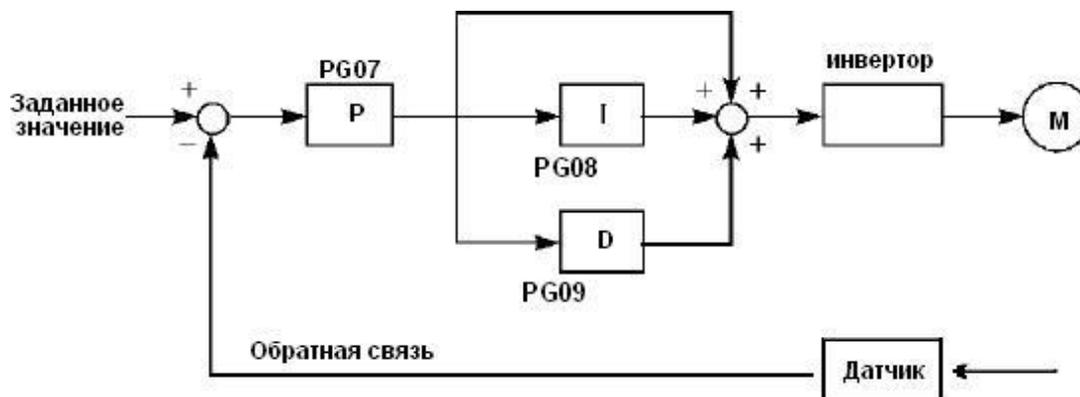
Замечания по использованию преобразователя в режиме PID-регулирования:
