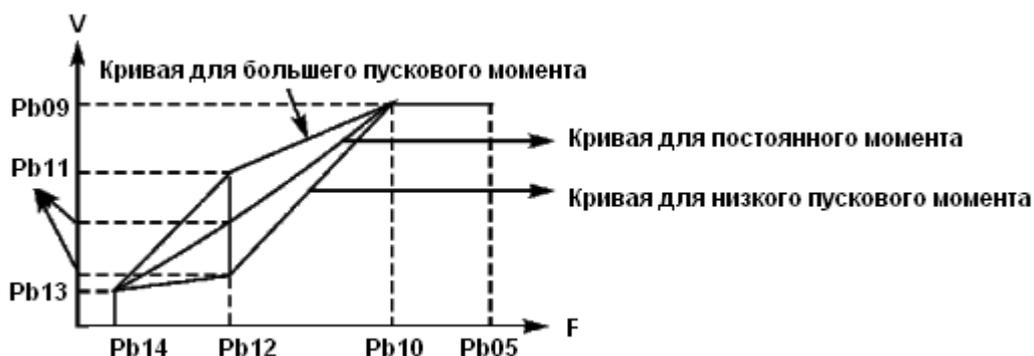
P<sub>b</sub>09: V/F-кривая: максимальное напряжение. Максимальное напряжение должно быть установлено в соответствии с моделью двигателя. В большинстве случаев это номинальное напряжение двигателя, но когда длина моторного кабеля превышает 30 м, значение параметра можно увеличить.
