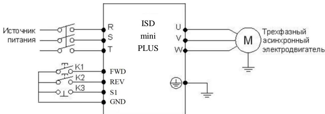
Пример работы преобразователя: Pb02=1, Pd15=6, Pd16=7, Pd17=8, Pd29=2
