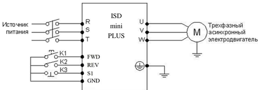
Пример работы преобразователя: Pb02=1, Pd15=6, Pd16=7, Pd17=8, Pd29=3
