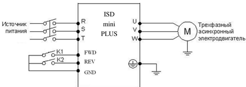
Пример работы преобразователя: P<sub>b</sub>02=1, P<sub>d</sub>15=6, P<sub>d</sub>16=7, P<sub>d</sub>29=0
