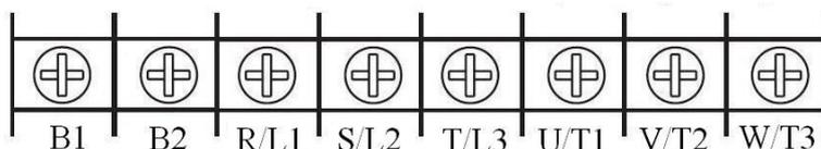
Момент затяжки винтов на силовых клеммах преобразователя 1,4 Н·м.
