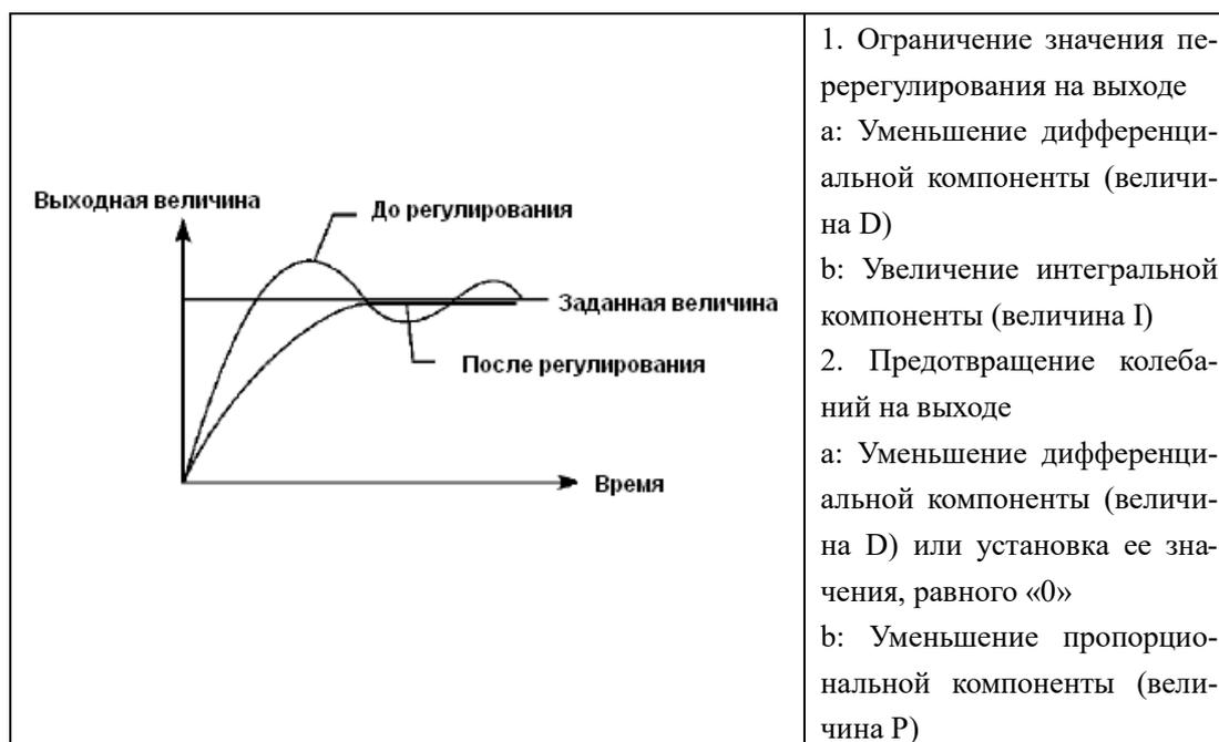
При использовании только P – закона регулирования возможна установившаяся ошибка регулирования с величиной до  $\pm 10\%$  от значения максимального сигнала обратной связи. Допустимая ошибка определяется величиной параметра PG20.
