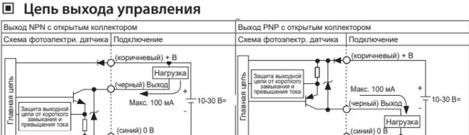
При возникновении короткого замыкания на выходе или превышении параметров питания, срабатывает защита выходной цепи от короткого замыкания или превышения тока и нормальный выходной сигнал не формируется.
