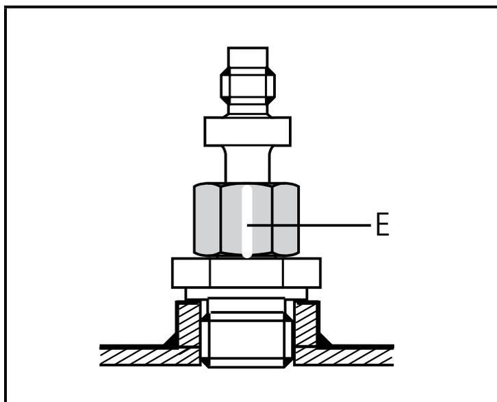
6. 必要な取り付けの深さにセンサーを調整し、その部分で袋ナットをスパナで締め付けてください。センサーが固定するまで袋ナットを締め付けてください。
