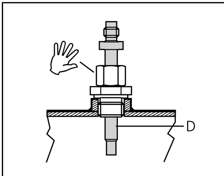
5. 手で袋ナットを締めて、その部分に線(E)を付けてください。
