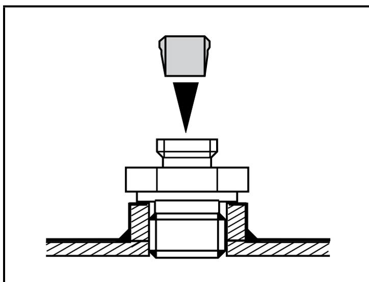
4. 袋ナットを取り付けて、センサー(D)を挿入してください。
