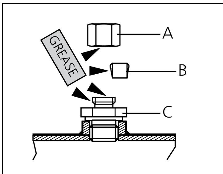
3. 継手にスリーブを置いてください。注意：継手のテーパ部分にスリーブを合わせてください。
