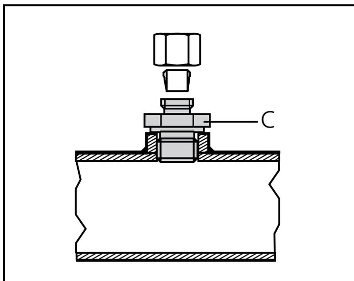
2. アダプターに焼付防止用のグリスを塗ってください。袋ナットのネジ部 (A)、スリーブ (B)、継手 (C) のネジ部とテーパ部分
