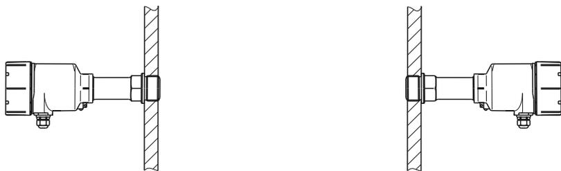
При установке в стенку емкости, кабельный ввод должен быть направлен вниз. Для герметичности используйте кабель соответствующего сечения.
