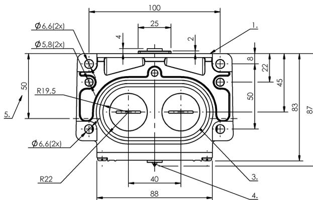
1) Опорная кромка, 2) Активная поверхность, 3) Уплотнительное кольцо, 4) Функциональный индикатор FD/FE/LL, 5) Кабельный ввод
