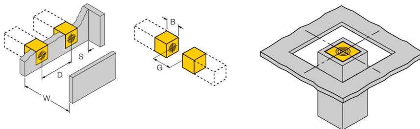
Если датчик устанавливается на перфорированную плату (листовой металл, наприм., подложка), то для надежного детектирования мишени он должен быть полностью утоплен в металл.
