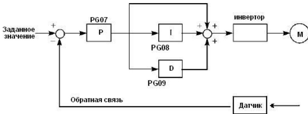
Замечания по использованию преобразователя в режиме PID-регулирования:
