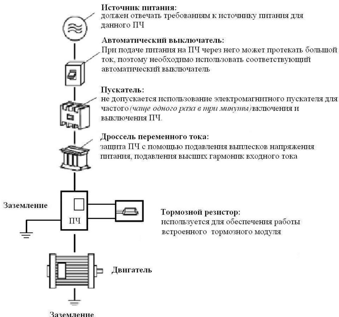
**⚠ Подключение проводов питания преобразователя следует производить только к клеммам S, R (T).**
