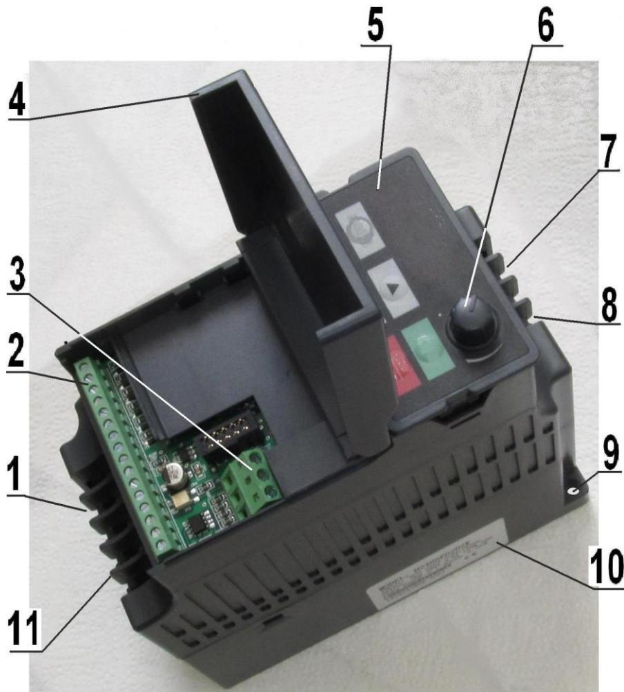
1. Клеммы для подключения электродвигателя U, V(W)\*
