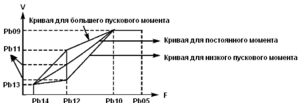
Pb09: V/F-кривая: максимальное напряжение. Максимальное напряжение должно быть установлено в соответствии с моделью двигателя. В большинстве случаев это номинальное напряжение двигателя, но когда двигатель находится в пределах 30 м от ПЧ, следует установить немного большее значение.
