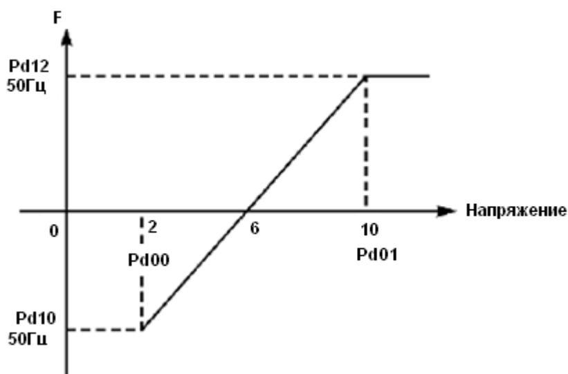
Примечание: Pd00=2, минимальное входное напряжение на входе FIV: 2 В (сигнал с напряжением ниже 2 В считается равным нулю);
