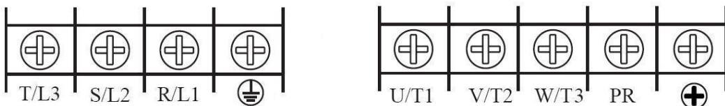
Тип корпуса 2. Однофазные, 220 В, мощностью от 1,5 кВт до 2,2 кВт (используются клеммы R(T) и S):
