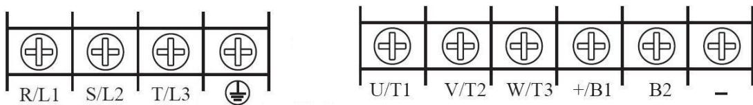
Момент затяжки винтов на силовых клеммах преобразователя 1.4 Нм.
