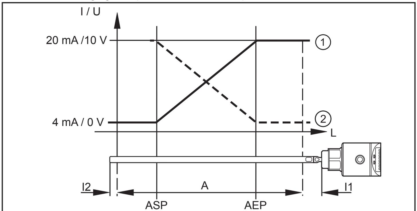
L: Füllstand; ASP: Analogstartpunkt; AEP: Analogendpunkt
