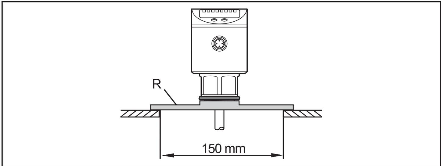
Um eine ausreichende Einkopplung des Messsignals zu ermöglichen, bei Einbau in Kunststoffbehälter oder Metallbehälter mit Kunststoffdeckel beachten:
