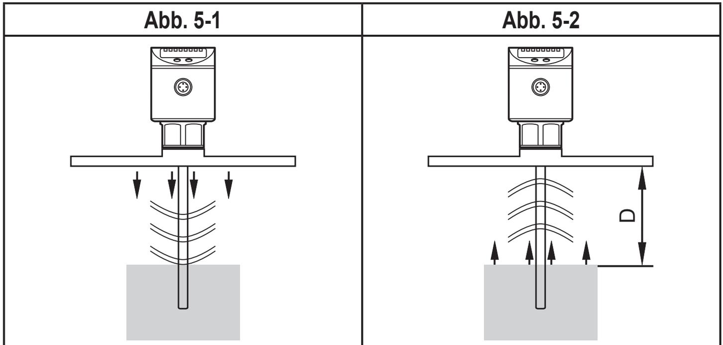
Das Gerät arbeitet nach dem Prinzip der geführten Mikrowelle. Es misst den Füllstand mit Hilfe elektromagnetischer Impulse im Nanosekundenbereich.
