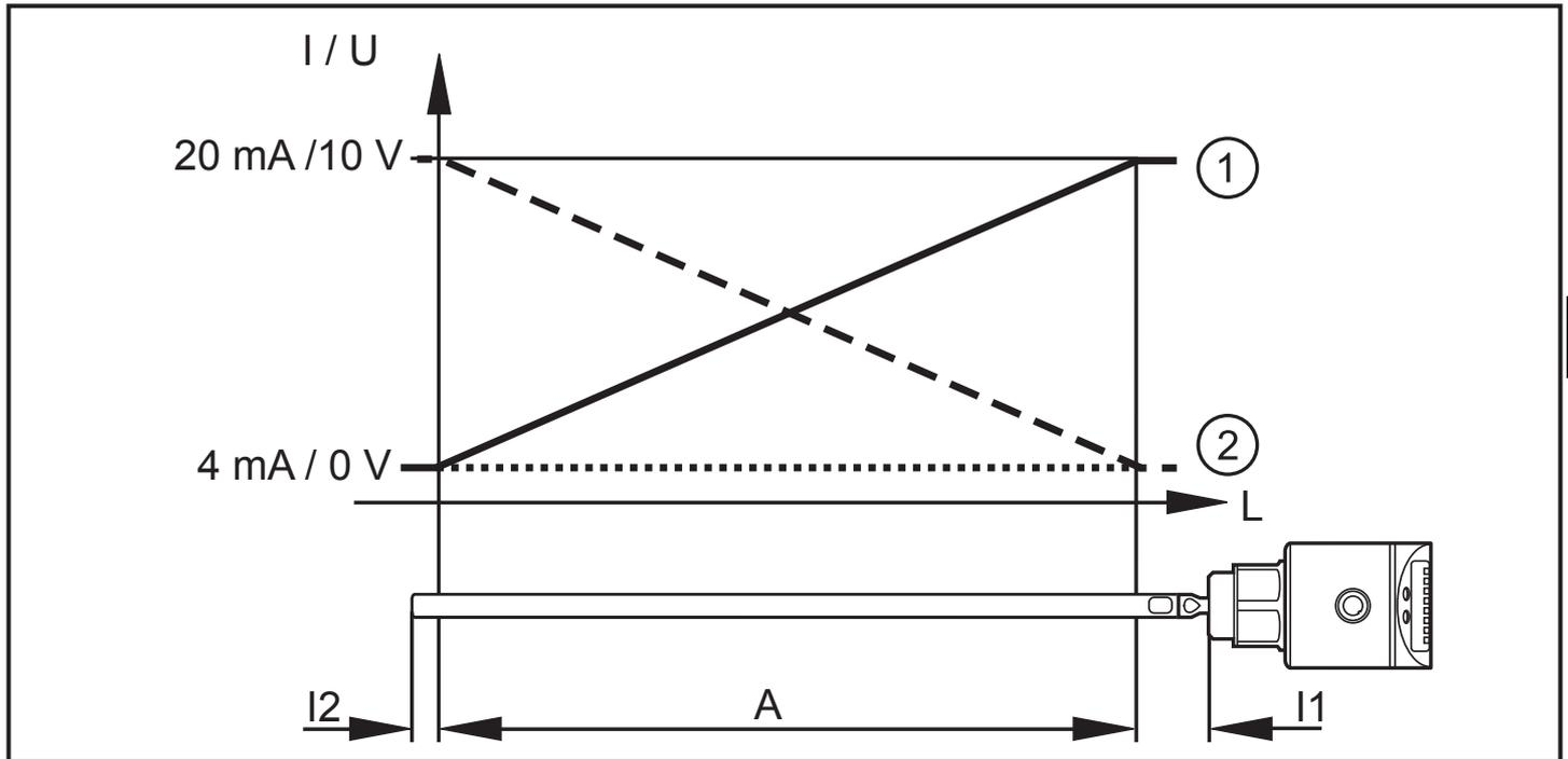
L: Füllstand; A: Aktiver Bereich; I1: inaktiver Bereich 1; I2: inaktiver Bereich 2 (→ Technisches Datenblatt); ①:  $[OU1] = [I] / [U]$ ; ②:  $[OU2] = [InEG] / [UnEG]$ .
