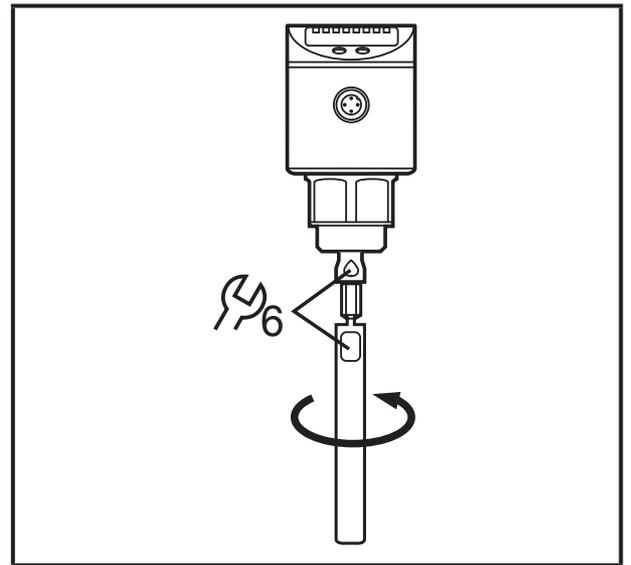
Bei hoher mechanischer Beanspruchung (starke Vibration, bewegte pastöse Medien) kann es notwendig sein, die Schraubverbindung zu sichern, z. B. durch Schraubensicherungslack.
