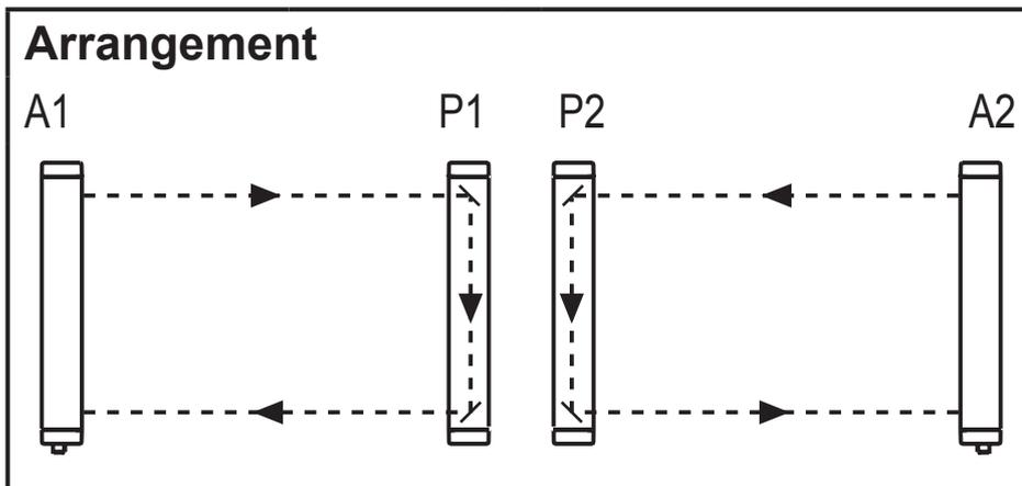
Position des deux éléments passifs l'un à côté de l'autre
