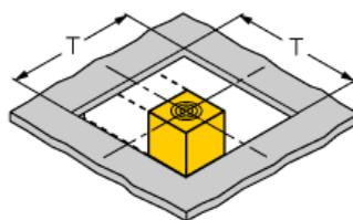
Приведенные значения соответствуют стальной пластине толщиной 1 мм.
