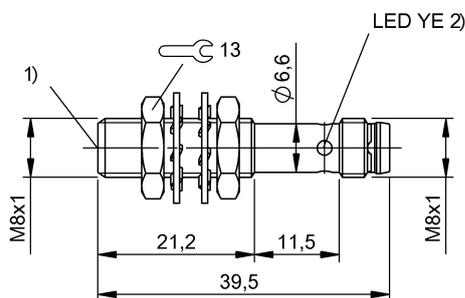
1) Оптическая ось, 2) Функция выхода
