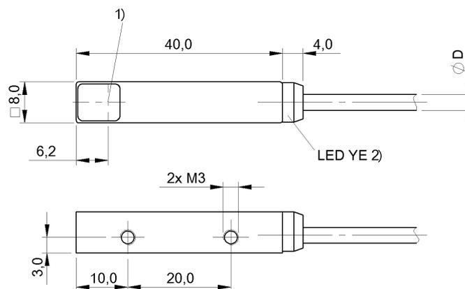
1) Оптическая ось, приемник, 2) Функция выхода
