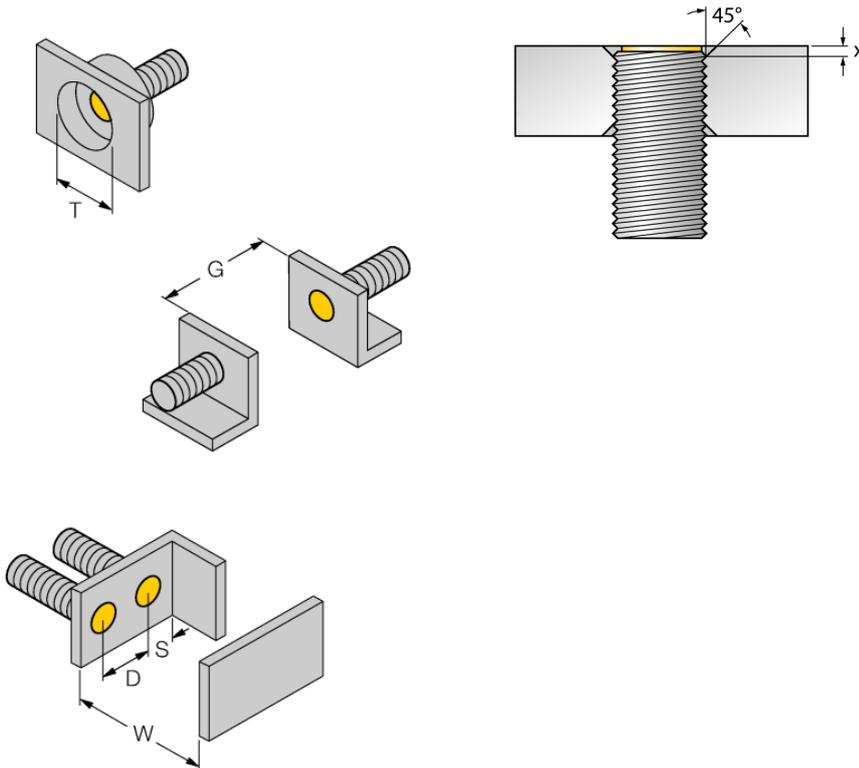
Установка заподлицо в латунных, алюминиевых и конструкциях из нержавеющей стали с применением комплектных гаек осуществляется без ограничений. Если установка осуществляется заподлицо в стальной конструкции, должны соблюдаться следующие требования: фаза 45° и мин. глубина 1,7 мм (размер X).
