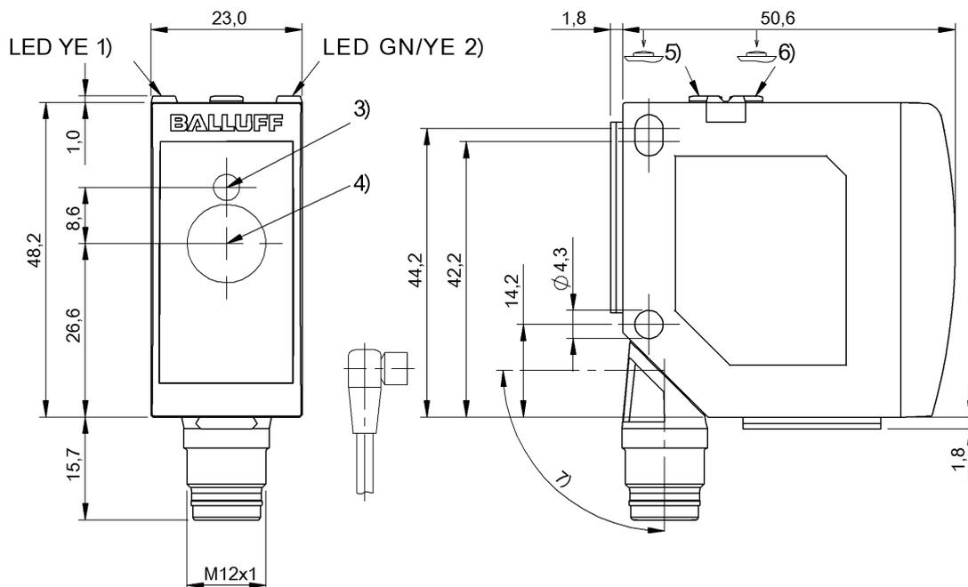
1) Функция выхода, 2) Напр. питания / аналог. выход, 3) Оптическая ось, передатчик, 4) Оптическая ось, приемник, 5) Коммут. выход запоминания, 6) Аналог. выход запоминания, 7) Поворачивается на 270°
