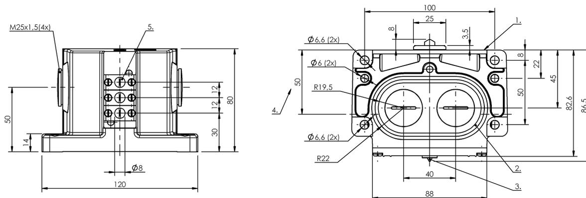
1) Опорная кромка, 2) Уплотнительное кольцо, 3) Функциональный индикатор FD/FE/LL, 4) Кабельный ввод, 5) Противокристаллизационный толкатель
