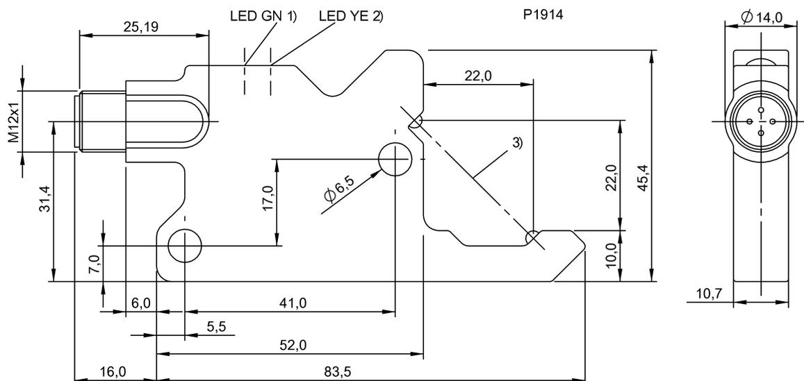
1) Напряжение питания, 2) Функция выхода, 3) Оптическая ось
