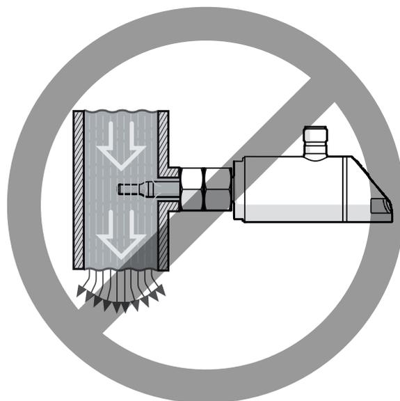
Не устанавливайте датчик в трубу, открытую снизу.
