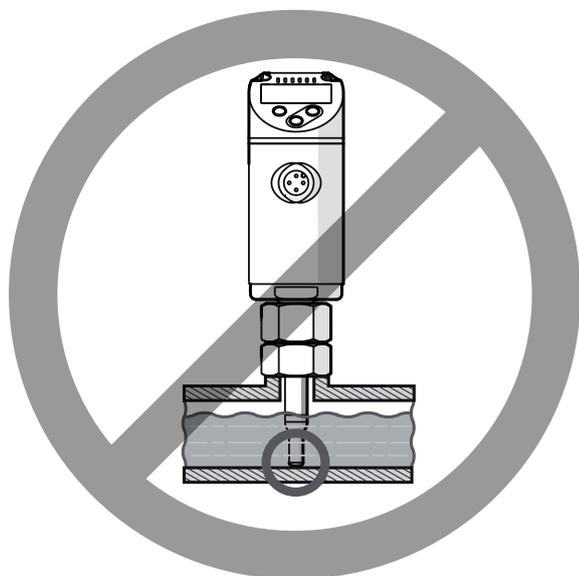
Наконечник датчика не должен касаться стенок трубы.
