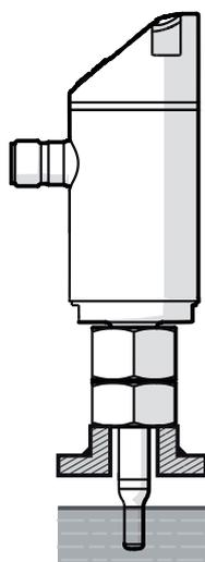
Наконечник датчика должен быть полностью погружен в среду.
