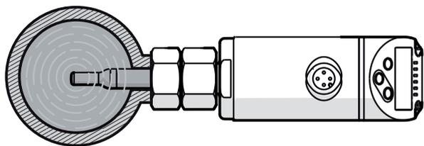
Для горизонтальных труб: установка сбоку.
