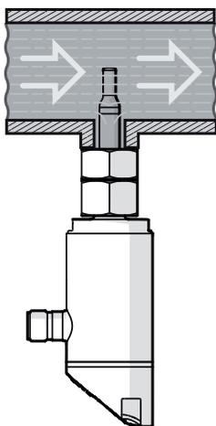
горизонтальная труба / монтаж снизу:
