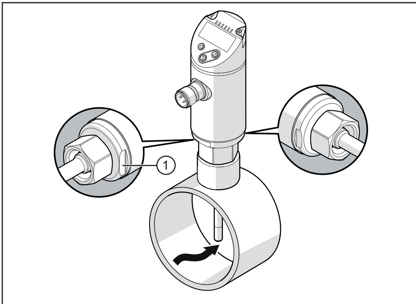
Для лучшей читаемости дисплея, корпус датчика можно вращать на  $345^\circ$ , что касается подключения к процессу.
