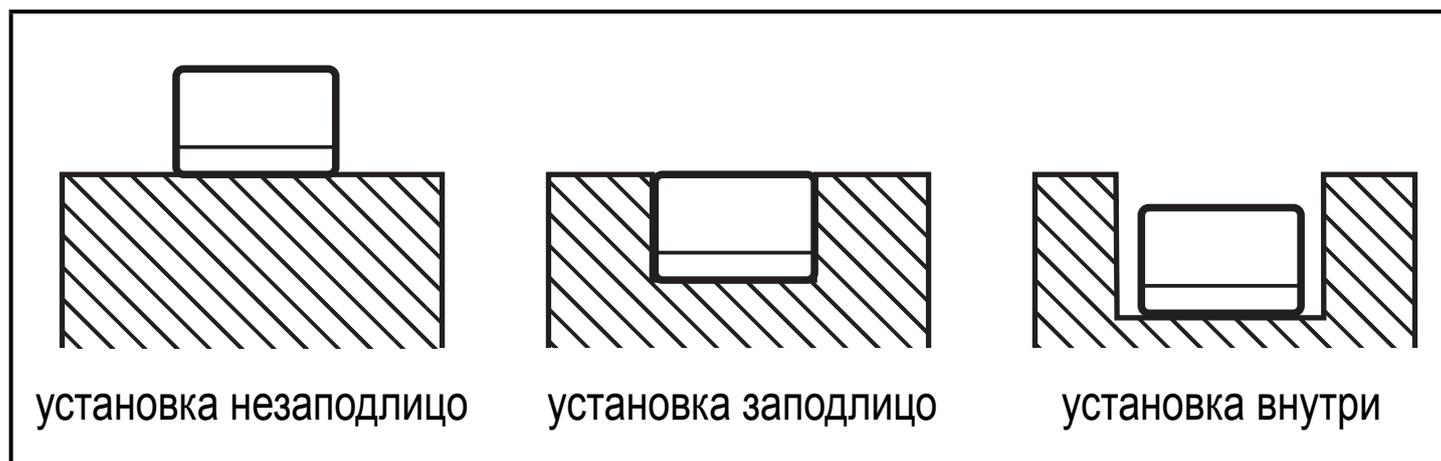
При установке в металле нужно оставить свободное пространство перед чувствительной поверхностью
