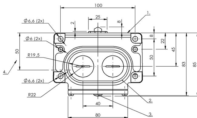
1) Опорная кромка, 2) Уплотнительное кольцо, 3) Функциональный индикатор FD/FE/LL, 4) Кабельный ввод
