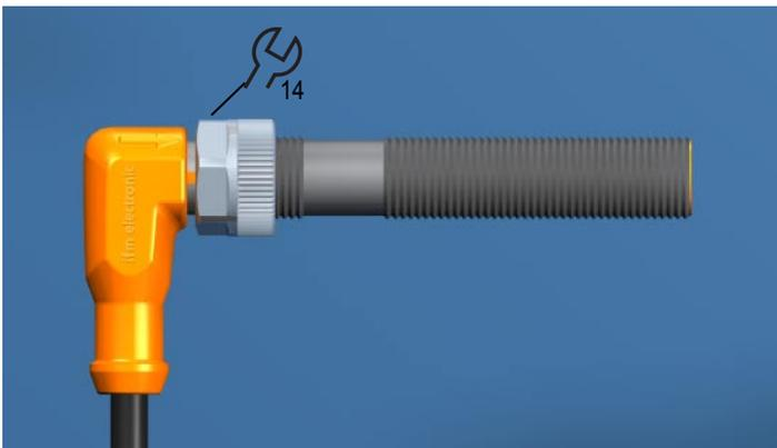
При эксплуатации в тяжелых условиях окружающей среды затяните накидную гайку дополнительно на один щелчок при помощи гаечного ключа (размером 14) для того, чтобы увеличить устойчивость к вибрациям и механическим воздействиям.
