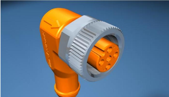
Подсоедините разъем к датчику; стрелка указывает на правильное положение ключа. Для обеспечения указанной степени защиты накидная гайка должна быть затянута с моментом затяжки от 0.6 Nm (затяжка вручную) до 1.5 Nm (затяжка с помощью динамометрического ключа).
