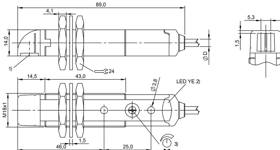
1) Оптическая ось, 2) Функция выхода, 3) Sn
