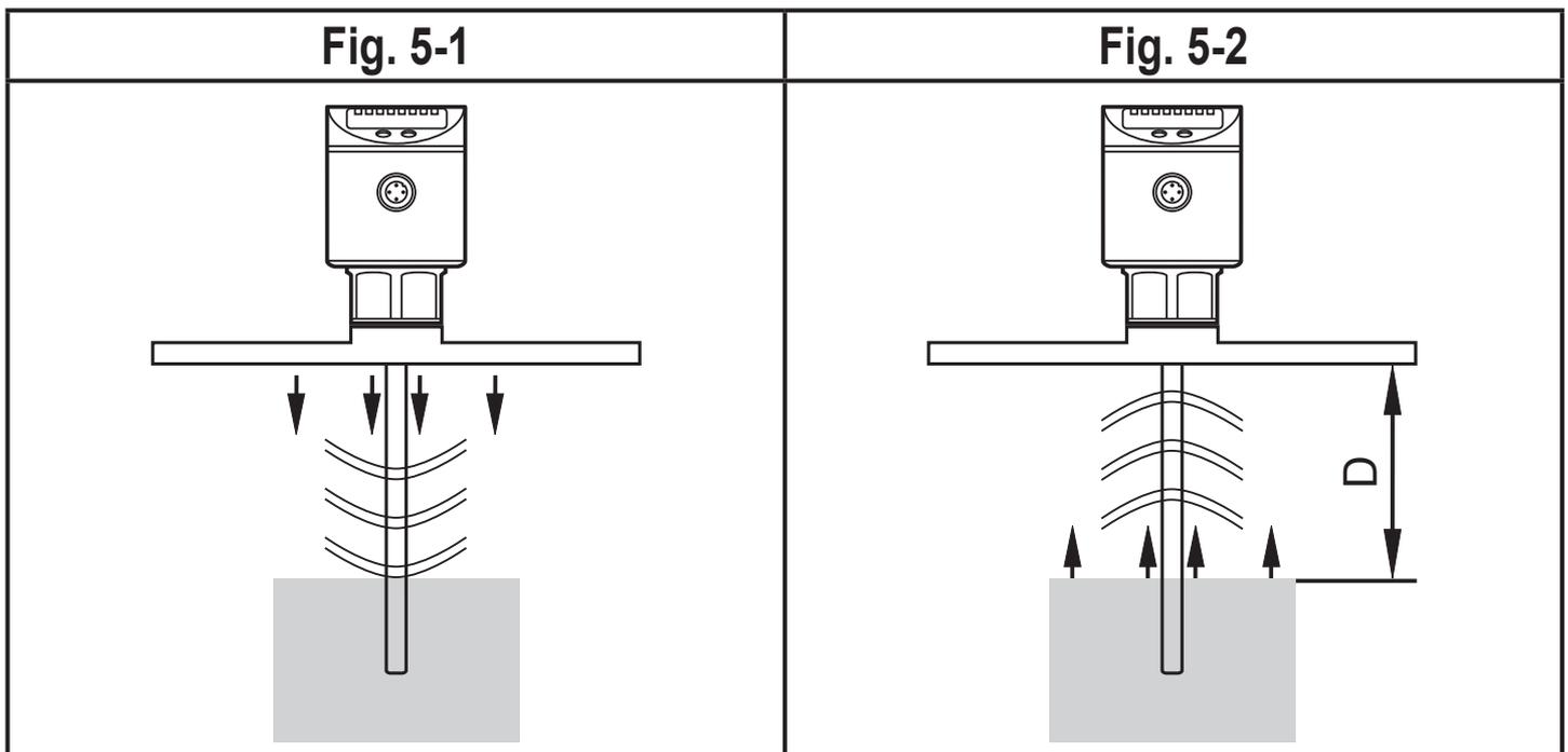
L'appareil fonctionne selon le principe du radar à micro-ondes guidées. Il mesure le niveau à l'aide d'impulsions électromagnétiques dans la plage des nanosecondes.
