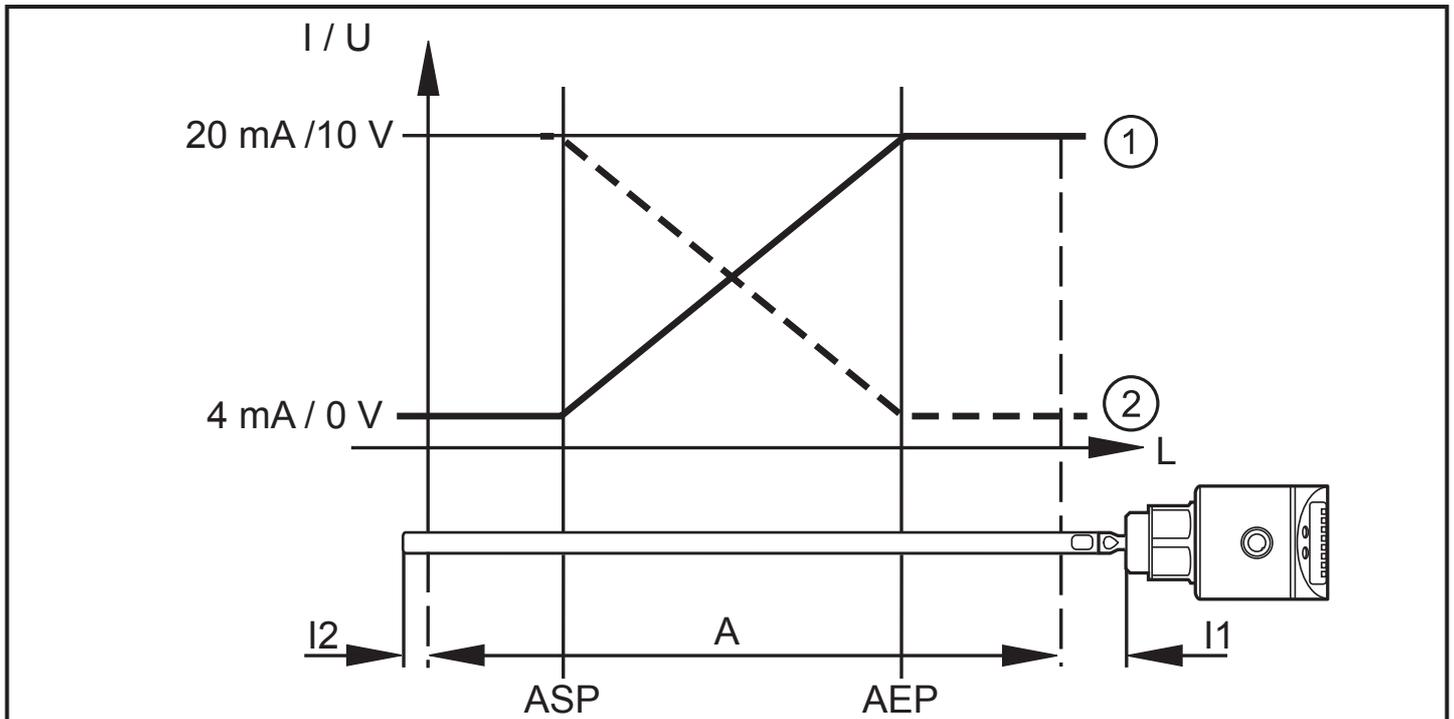
L: niveau ; ASP : valeur minimum de la sortie analogique ; AEP : valeur maximum de la sortie analogique
