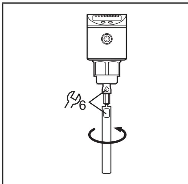
En cas de sollicitation mécanique importante (fortes vibrations, fluides visqueux en mouvement) il peut être nécessaire de sécuriser le raccord vissé, par ex. en utilisant un adhésif frein-filet.
