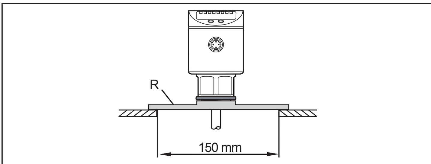
Pour permettre une injection suffisante du signal de mesure, si monté dans une cuve plastique ou dans une cuve métallique avec couvercle en plastique, respecter :
