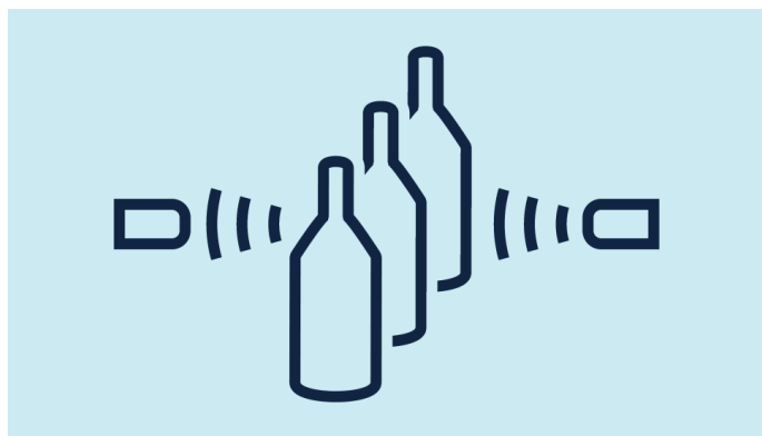
Принцип действия ультразвуковых сквозных барьеров
