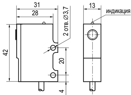
**Выключатель оптический бесконтактный
